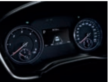
Цифрова панель приладів SUPER VISION 4,2" Full TFT LCD
