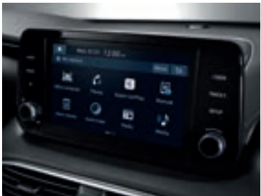
Мультимедійна система з кольоровим сенсорним 8" LCD монітором
